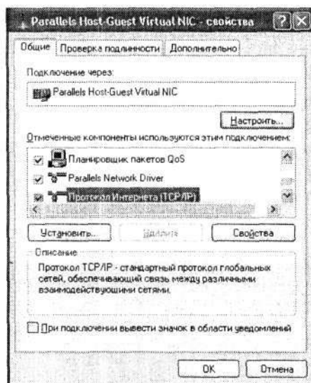
Рис. 4.50. Назначение статического IP-адреса для хост-компьютера
